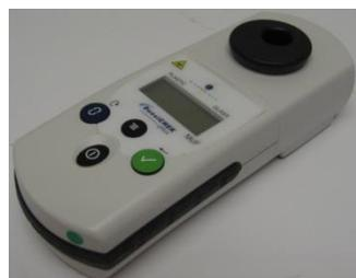
Оценить плотность суспензии микроорганизма с помощью денситометра
